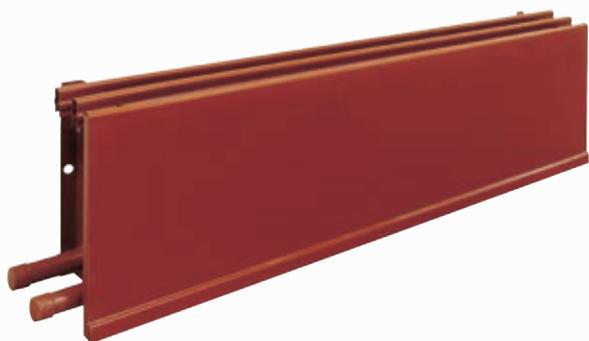
Конвекторы отопительные стальные настенные с кожухом предназначены для индивидуальной и групповой установки в системе центрального отопления общественных, производственных и жилых зданий. Конвекторы выпускаются в полной строительной готовности в концевом и проходном исполнениях с гладкими концами труб под сварку или, при заказе, с резьбой для соединения муфтами.
