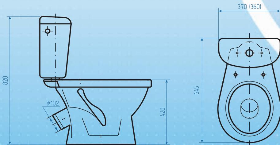
Унитаз-компакт воронкообразный, с косым выпуском и цельноотлитой полочкой в комплекте с бачком «Малыш» под кнопку (боковая подводка воды). Может комплектоваться бачком «Уни» под кнопку (боковая подводка воды). Изделие соответствует ГОСТ 13449-82. «Изделия санитарные керамические. Методы испытаний».
