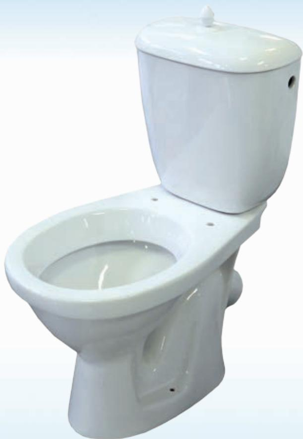
Унитаз-компакт воронкообразный, с косым выпуском, и цельноотлитой полочкой. Может быть укомплектован бачком «Уни» под кнопку (боковая подводка воды), под шток (боковая подводка воды), бачком «Евро» под кнопку (боковая или нижняя подводка воды), под шток (боковая подводка воды). Изделие соответствует ГОСТ 13449-82. «Изделия санитарные керамические. Методы испытаний».
